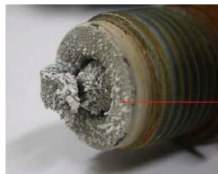
Fig. 1 Dépôts sur les éléments d'un moteur fonctionnant au biogaz (siloxanes) [3].
