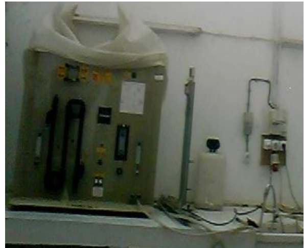
Fig. 1: dispositif expérimental Bond D'essai : Echangeurs thermiques Eau/Eau En Ecoulement Turbulent H 951.
