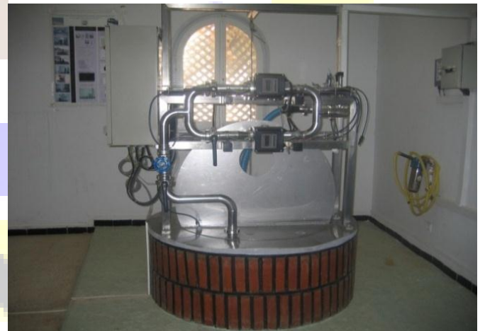
Fig. 3 Banc d'essai de pompage (Laboratoire pompage solaire URAER)
