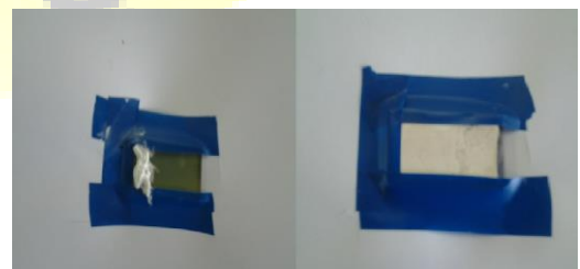
Fig. 8 Application de la pâte de TiO 2
