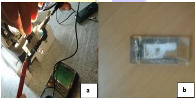
Fig. 13 (a) test de la cellule, (b) cellule dégradée
