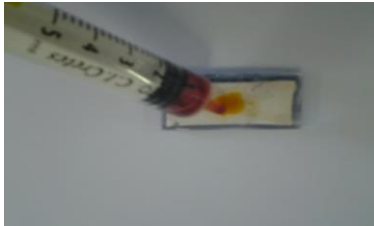
Fig. 9 Injection du colorant sur la couche de TiO 2
