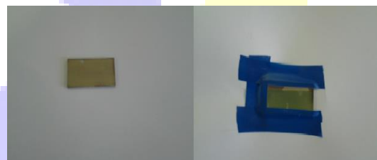
Fig. 7 Application de 3 bandes de ruban adhésif sur le substrat en verre conducteur
