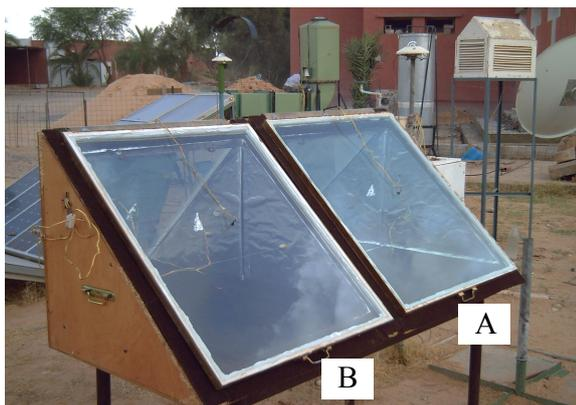
Fig. 3. Photographie montrant les cuiseurs solaires utilisés dans la présente étude expérimentale comparative, placés côte à côte sur la plate forme des essais. 'A' est équipé de la plaque absorbante ordinaire et 'B' est équipé de la plaque absorbante à ailettes.
