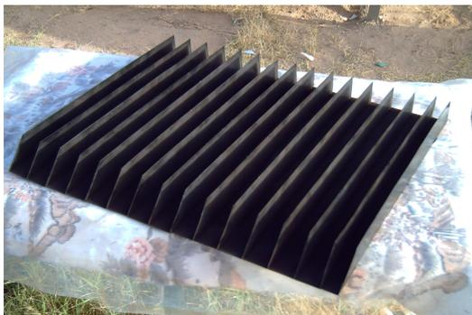
Fig. 2. Photographie montrant la plaque absorbante à ailettes.
