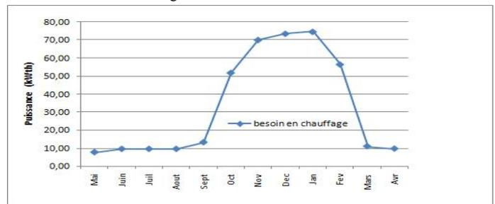
Fig. 2: Puissance du besoin en chauffage
