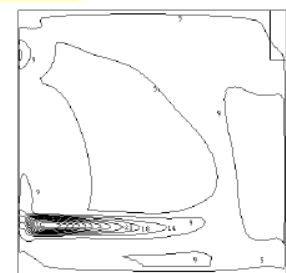
Figure 32. Contours de vitesse dans un plan horizontal : y=1.80\text{m} , y=2.50\text{m} et I=20\% (numérique) [1].
