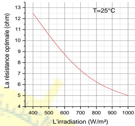
Fig. 9 La résistance en fonction de l'irradiation.
