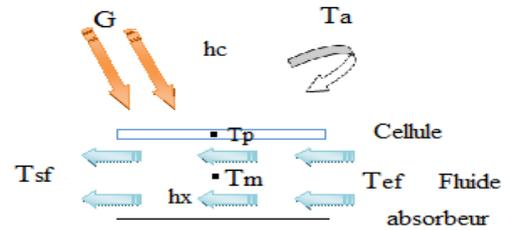
Fig. 4 Représentation de passage du fluide entre la cellule et l'absorbeur
