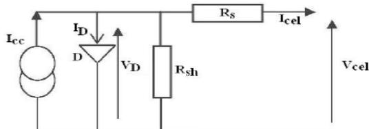
Fig. 2 Schéma électrique équivalent d'une cellule photovoltaïque
