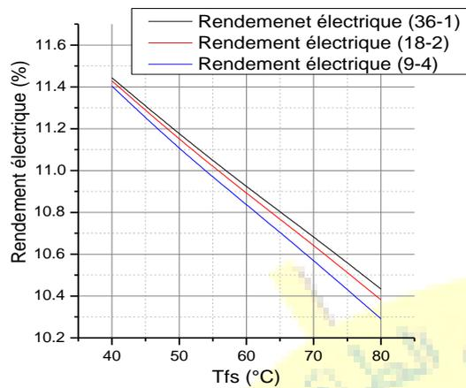
Fig. 15. Le rendement électrique des trois modes de refroidissement en fonction de la température de sortie.
