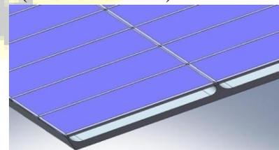
Fig. 3 section de passage du fluide caloporteur
