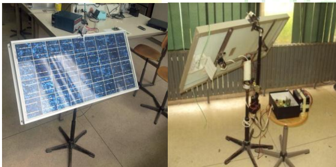
Fig. 8 Photo du système de poursuite solaire réalisé au département xx, USTHB
