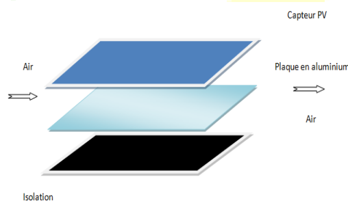
Fig.1. Capteur hybride à air variable étudié
