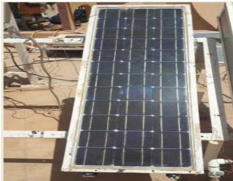
Fig. 2. Photo du prototype capteur hybride PVT à air
