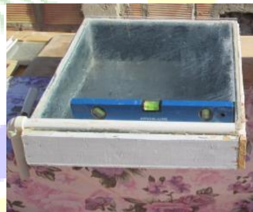
Fig. 1. Le distillateur solaire
