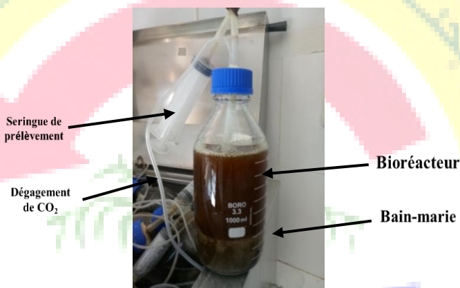
Fig 3. Dispositif expérimental de la fermentation alcoolique
