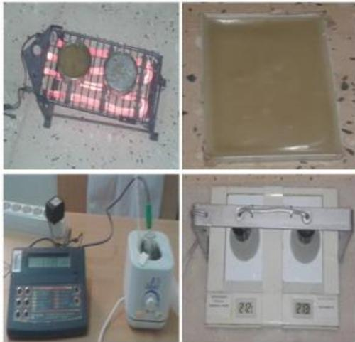
Fig. 2 . Préparation et caractérisation du mélange de la paraffine et graisse du mouton acceptable (Résistance; MCP-DR) préparé ; conductivimètre ; bain thermostatique et Montage de caractérisation type méga)
