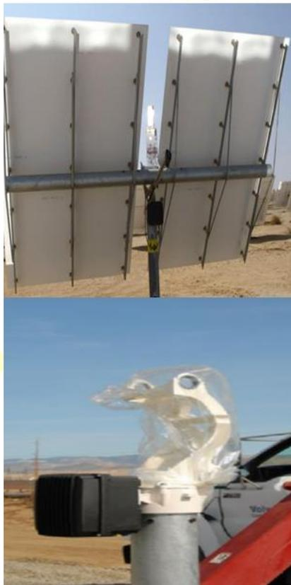
Fig. 7 Gauche : héliostat LH 2.2 de BrightSource ; Droite : support de palier [18,15].
