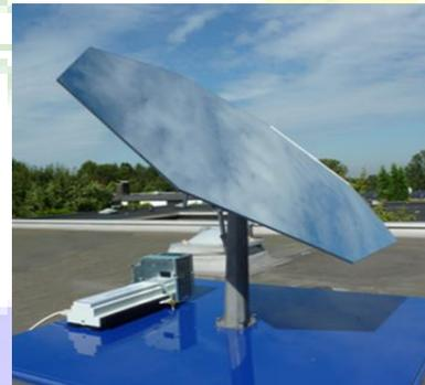
Fig. 16 Solaflect héliostat [30].
