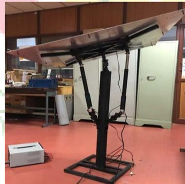
Fig. 12 Héliostat Pitch/Roll de l'Université Amrita.
