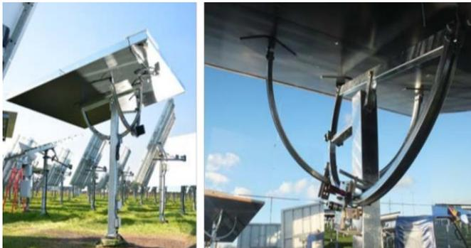
Fig. 13 Actionneurs de jante de l'héliostat DLR [25].
