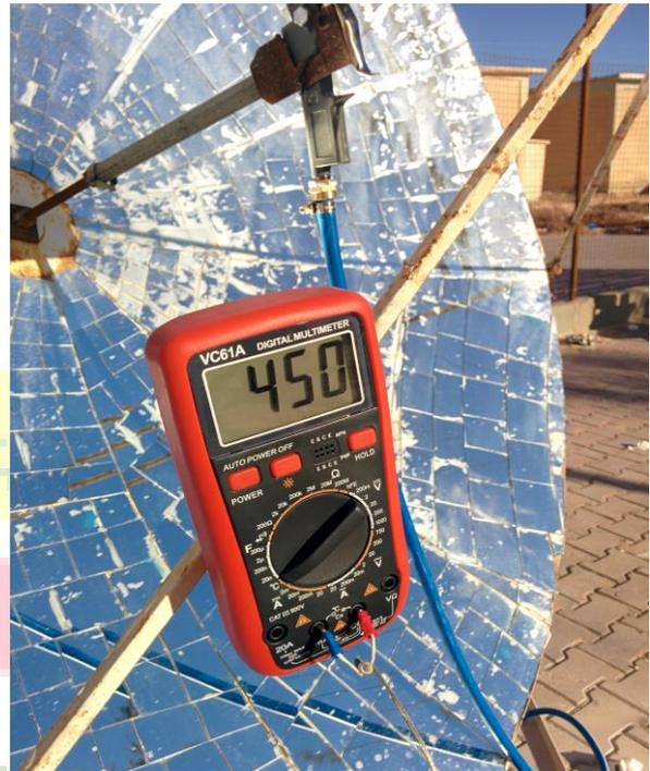
Figure. 7: température au niveau de foyer
