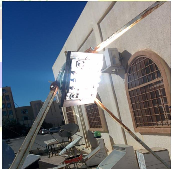
Figure. 6: foyer sous flux solaire
